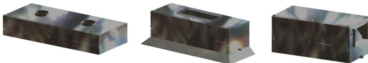
В ВЗГ-8 применяются 2 варианта изготовления съёмной двери, с боковыми отгибами и защёлками и без. Зонты с дверью без боковых отгибов можно устанавливать вплотную друг к другу и к стене, зонты с дверью с боковыми отгибами только с зазором от стен и соседних зонтов не менее 100 мм. Дверь с боковыми отгибами устанавливается по умолчанию на зонты ВЗГ-8.1ФкР и ВЗГ-8.1ФкРх2.
