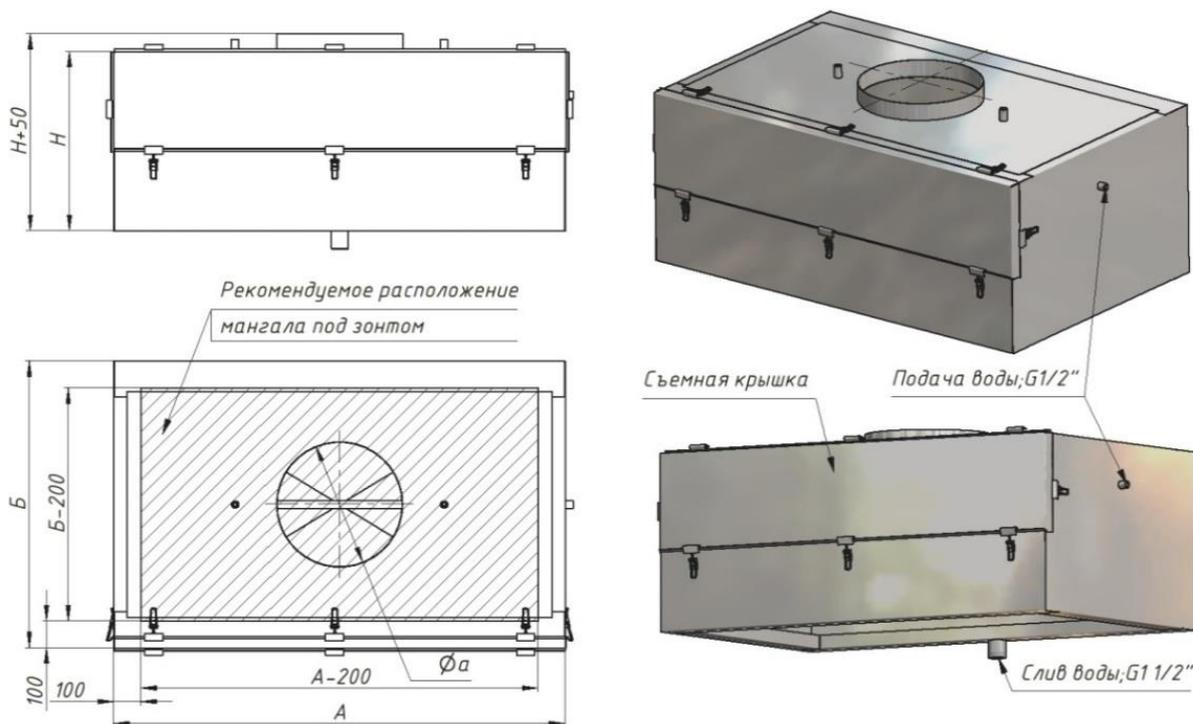
Модификации зонта в зависимости от комплектации:
