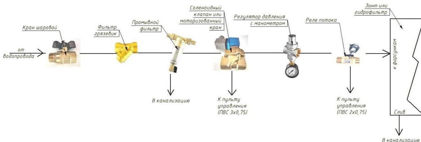
1. Рабочее давление в водопроводной сети должно быть не менее 2-х атм. При большем давлении регулятором давления устанавливается давление 2 атм. При меньшем давлении в магистраль встраивается повысительный насос.
