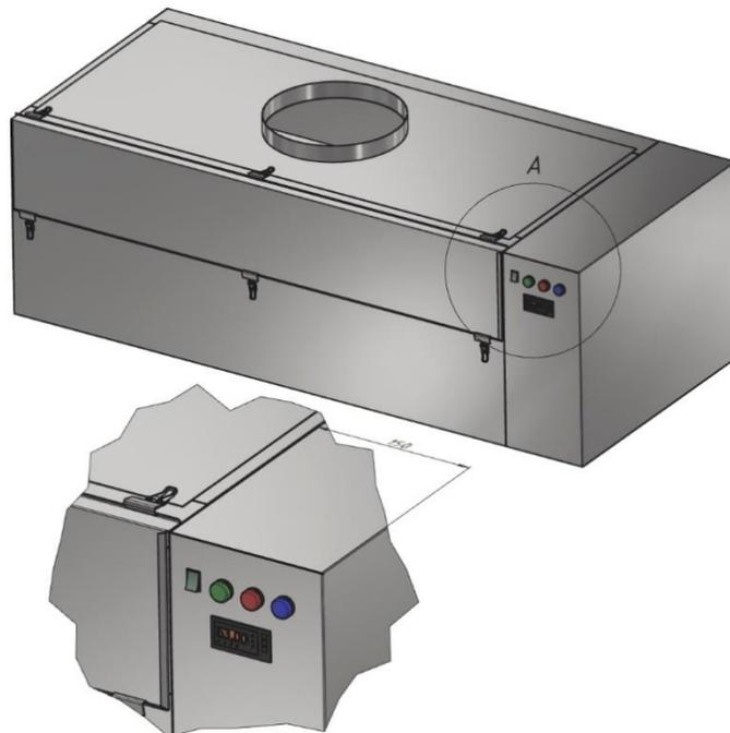
Пульт устанавливается на боковую панель, справа или слева и соединяется с датчиками и исполнительными элементами кабелями. Все датчики и исполнительные элементы монтируются на зонте. Монтаж выполняется на производстве. Размеры пульта определяются размерами зонта и необходимым функционалом.
